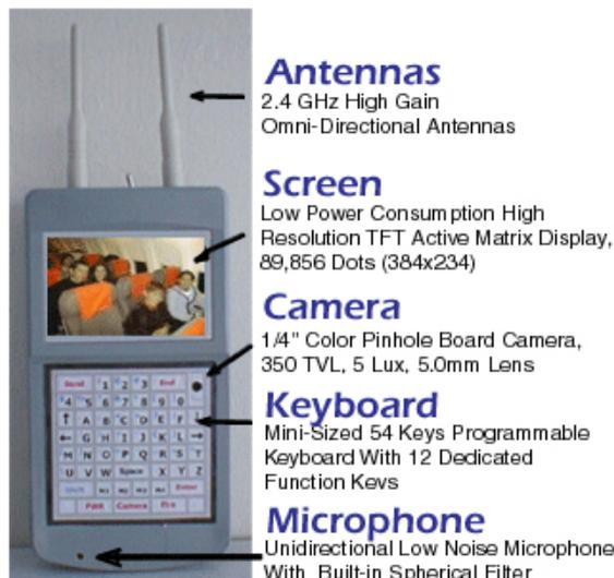
米 IMRC テクノロジー社は、2.4GHz 帯を使ったワイヤレス・ポータブルテレビ電話 (VDA) を販売している。アンテナは全方位型を使い、スクリーンは、89,856 ドット表示の TFT アクティブマトリクス表示、内蔵カメラ、マイク、そしてキーボードと見た目にはトランシーバーに付いたテレビ電話機能という感じのもの。ピアツーピアで交信をしたり、パソコンをインターフェイスにしてインターネット経由で通信したりということができそう。また、デスクトップモデルもある。
