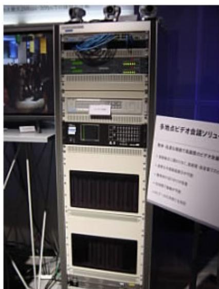
ついてだが、従来の多地点接続機能の考え方とは違う発想で設計されたシステム(写真左)で、拠点数に合わせて写真下部に対向で PCS-1 を搭載する。(白い部分)
