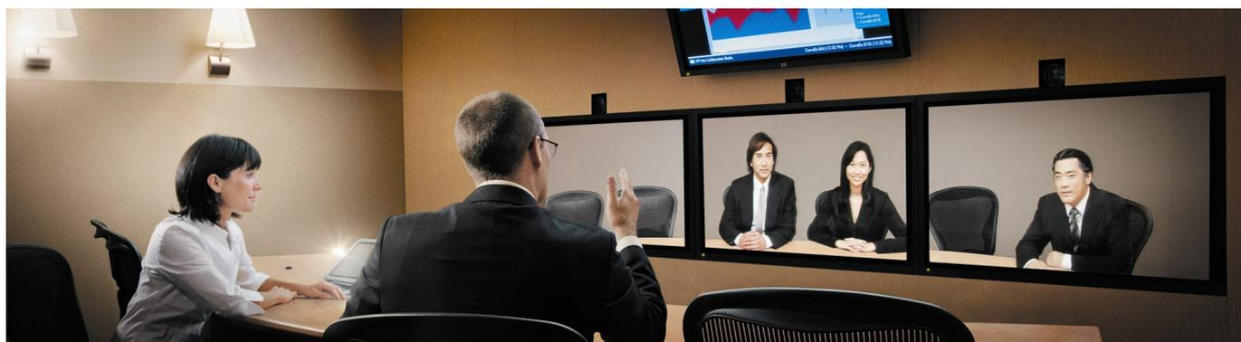
人が映っている画面を「ピープルスクリーン」、上部のデータを表示しているのを「コラボレーションスクリーン」と呼ぶ。人の等身大に近い大きさで映るように工夫されている。3つのプラズマディスプレイ画面の上側にある3つの黒い四角は、HD(ハイビジョン)カメラが格納されている。写真上の白い服を着た女性の向こう側に見える黒い点ぐらいの大きさがマイク(6人がけテーブルに3つある)。また、Halo システムのオン/オフ、相手先の接続などはアイコンがコラボレーションスクリーンに表示されるため、テーブルに置いてあるマウスを使って各種操作を行う。
