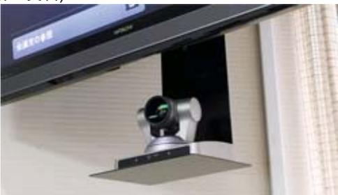
天井から吊した片方のモニターには、モニターと一体になったカメラ台座をオリジナルで製作(日立製作所 資料)
