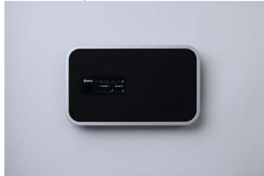
外観や性能は同じだが端子を USB とオーディオケーブルに絞った R-Talk 800PC(NTT アドバンステクノロジー 資料)
