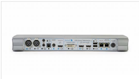
豊富な入出力端子を備える--本体:高さ 40mm 幅 365mm 奥行 110mm 従量 1.1kg(メディアプラス 資料)
