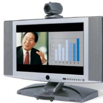
TANDBERG 1500MXP(写真上)は、役員室向けに最適。17 インチワイド液晶モニター、カメラ、マイクを内蔵した一体型システム。机の上に置いて使用することを想定しているため、PC モニターとしても使える。暗号化機能(AES)、多地点接続機能、プレゼンテーション機能を持つ。
