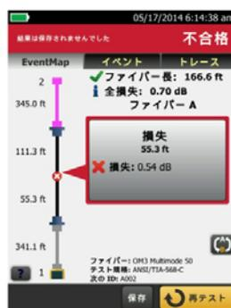
マルチモードでのイベント・デットゾーンは 0.5m と業界最小クラスを達成し、より正確な障害箇所の迅速な特定が行えるようになっている。
