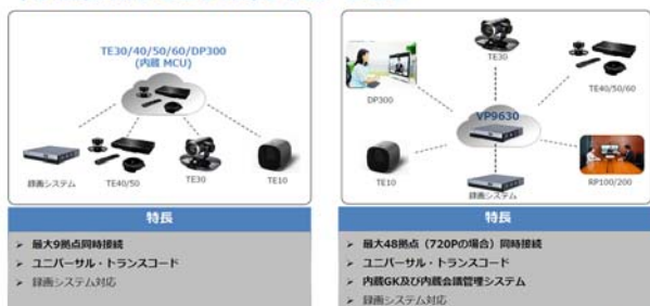
TE10などを組み合わせた中小企業向け導入例 (ファーウェイ・ジャパン)
